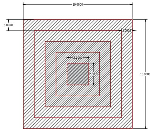
pianta dello scavo 10x10 m
