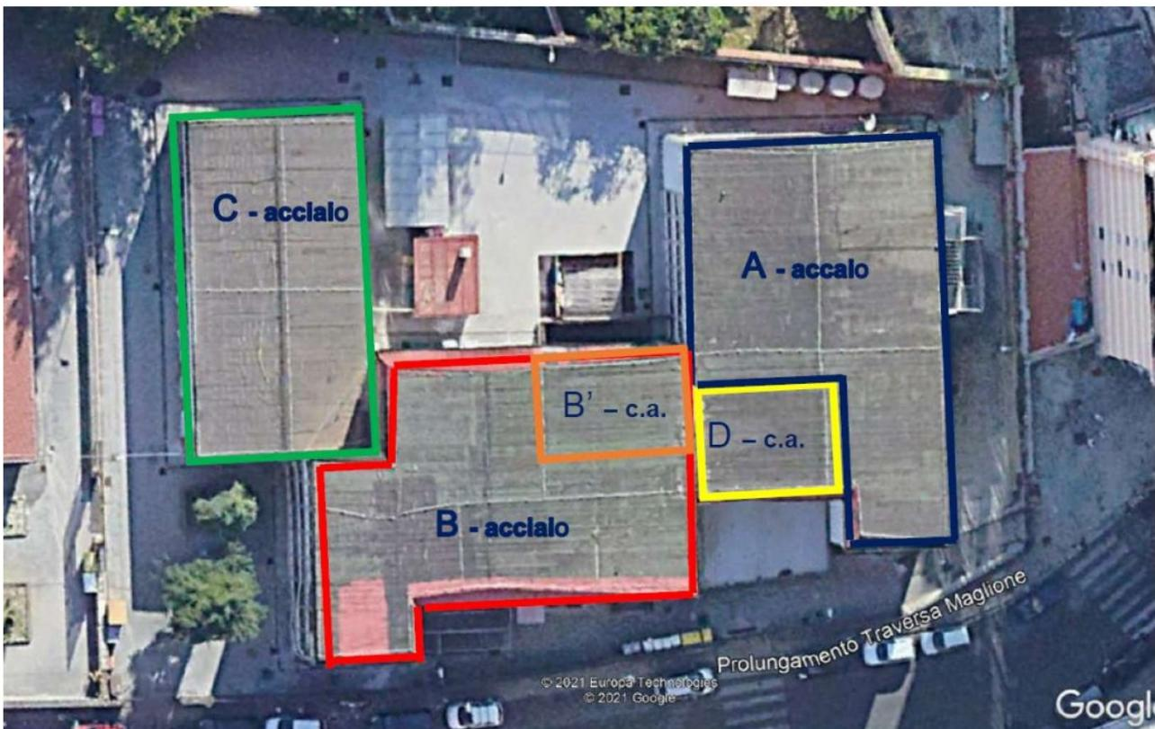
Figura 4 – schema planimetrico con individuazione dei corpi strutturali
