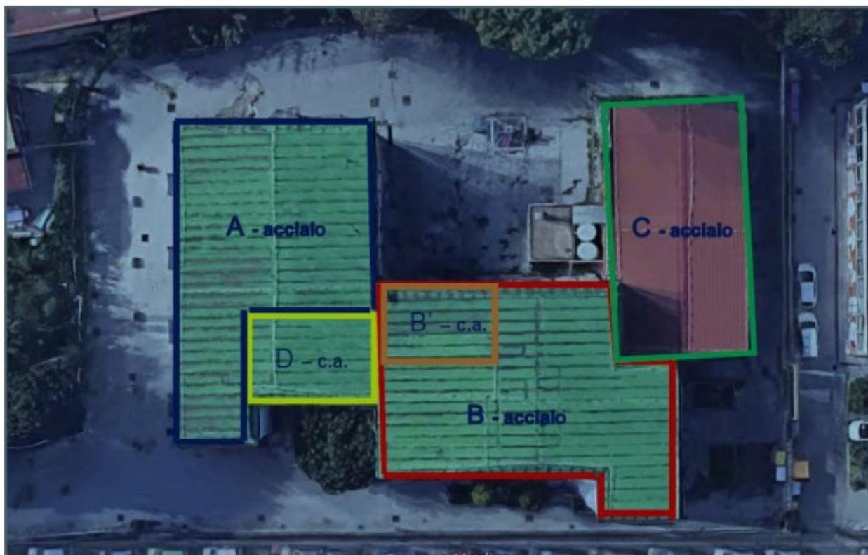
Figura 6 – schema planimetrico con individuazione dei corpi strutturali
