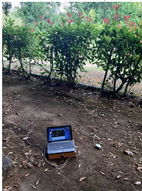
Prova sismica HVSR
