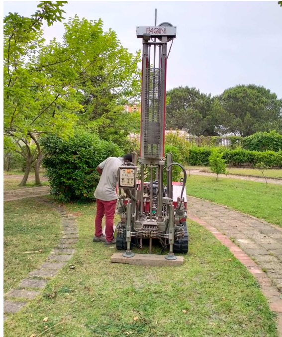
Esecuzione prova P1 (DPSH)
