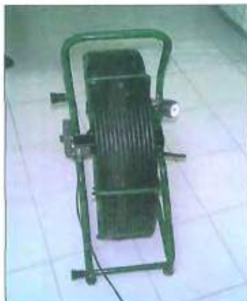
Foto 25 Cavo con all'estremità la telecamera
