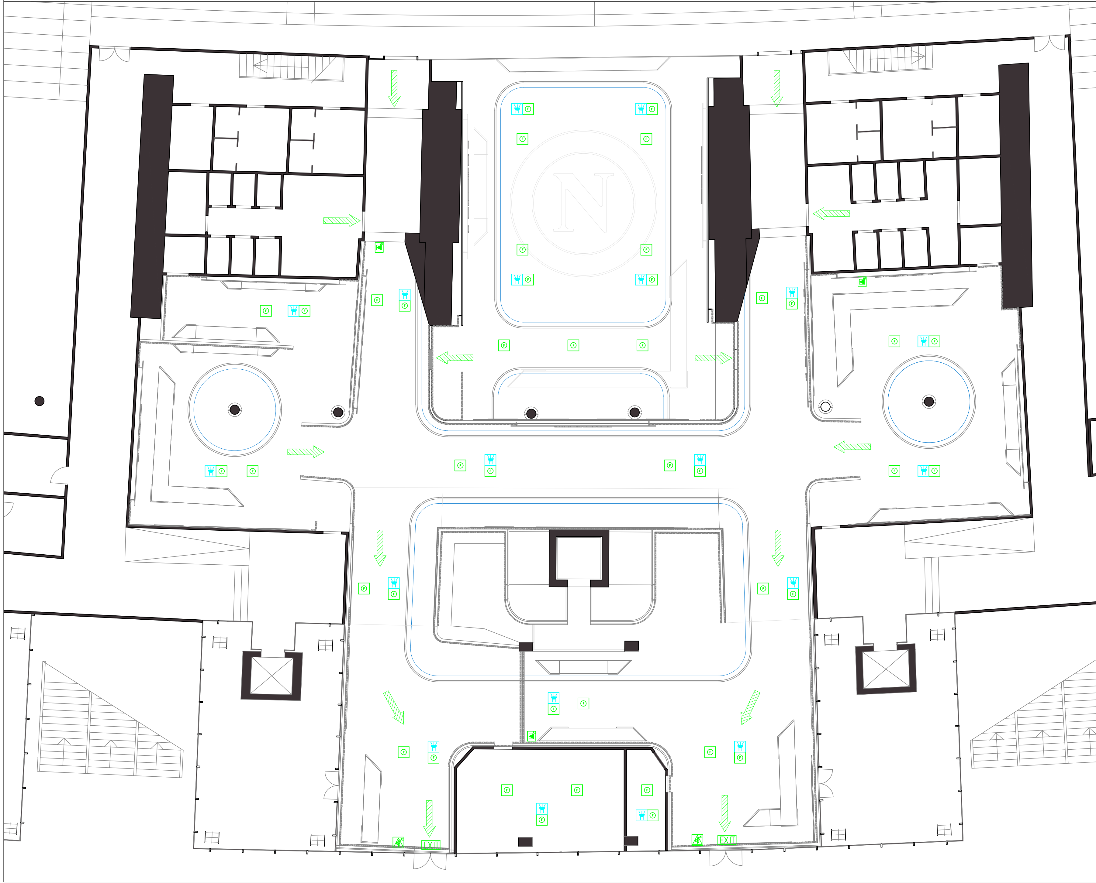
PLANIMETRIA VIE DI FUGA, RILEVATORI ED USCITE DI EMERGENZA - STATO FUTURO - scala 1:100
