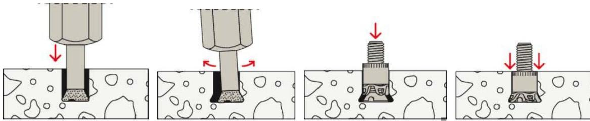
Dettaglio geometria foratura NON PASSANTE della lastra da eseguire con punta diamantata Fischer FZBP
