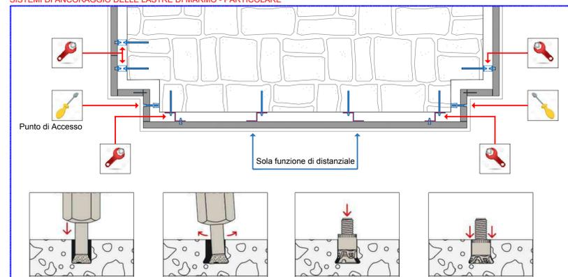
FASI DI REALIZZAZIONE IN CANTIERE DEL FORO SOTTOSQUADRO - CON SISTEMA " FISCHER"
