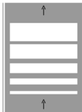
Sulla base delle indicazioni progettuali ovvero della Direzione Lavori, i sistemi di rallentamento ad **effetto acustico** saranno realizzati mediante irruvidimento della pavimentazione stradale ottenuta con la scarificazione
