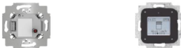
Il termostato è utilizzato per il controllo della temperatura ambientale. Può essere impiegato come regolatore a soglia, come regolatore proporzionale a larghezza d'impulso ON/OFF (PWM) oppure come regolatore proporzionale integrale (PI) per realizzare il controllo della temperatura (riscaldamento o raffrescamento).
