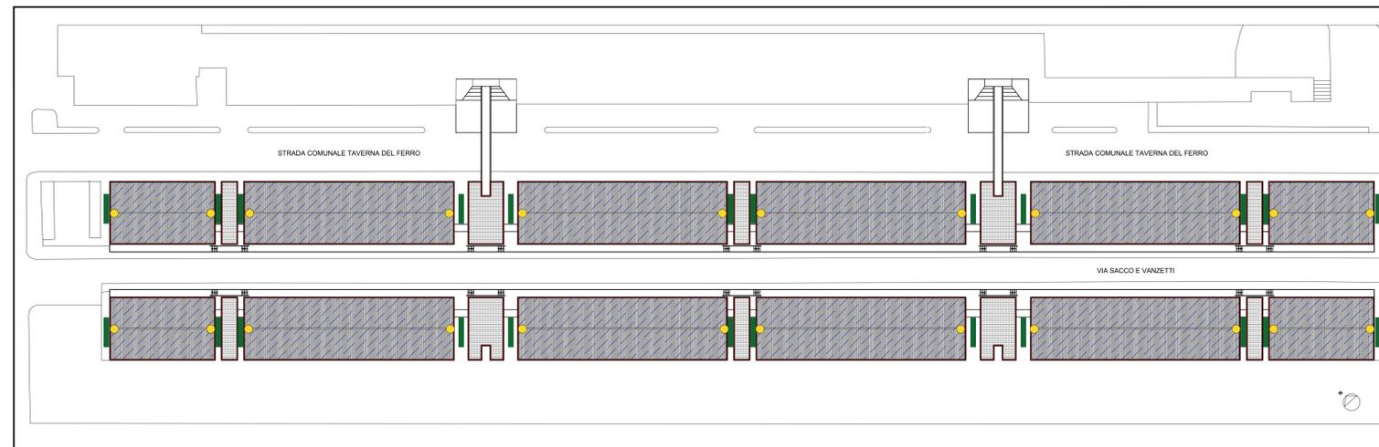
**POSIZIONAMENTO DI PONTEGGI NELLE VARIE FASI DI LAVORAZIONI (dimensioni 6m x 1m)**
