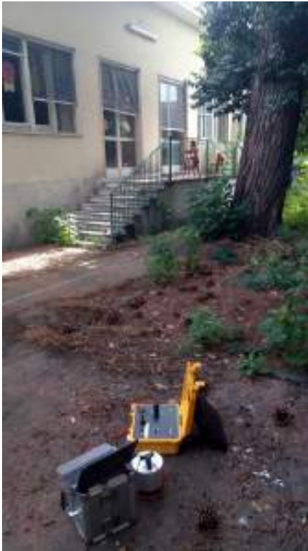
Foto 1 - 2- Stendimento sismico MASW 1 – TOMO1 + Prova di sismica passiva HVSR1
