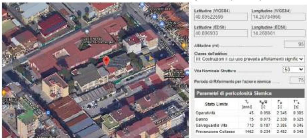
Figura 8: Parametri di pericolosità sismica di base
