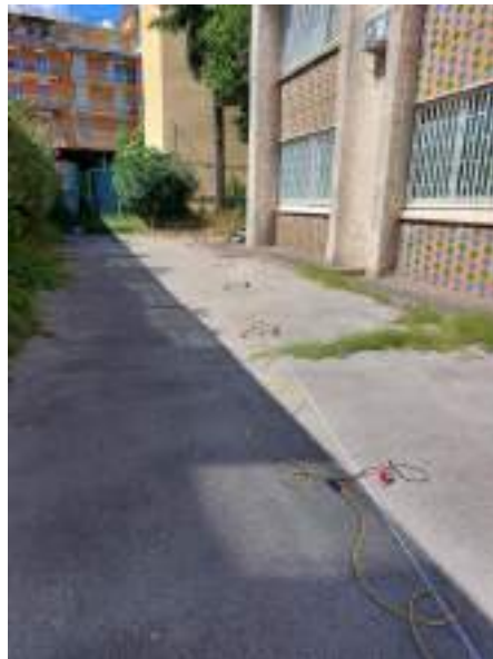
Foto 2- Stendimento sismico MASW 1 – TOMO1
