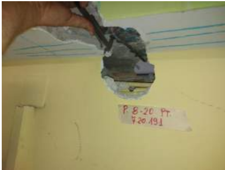
Figura 15 – Pacometria Trave P 8-20 – II impalcato
