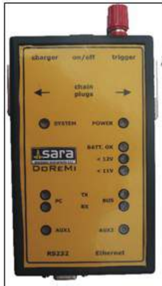
Sismografo DOREMI della Sara Electronic Instruments s.r.l.
