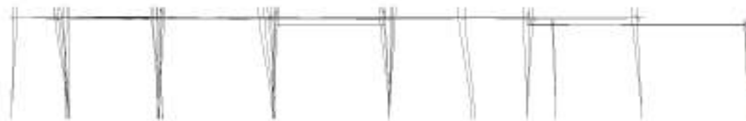
Figura 30a - Deformata SLV (+y) c.f.1
