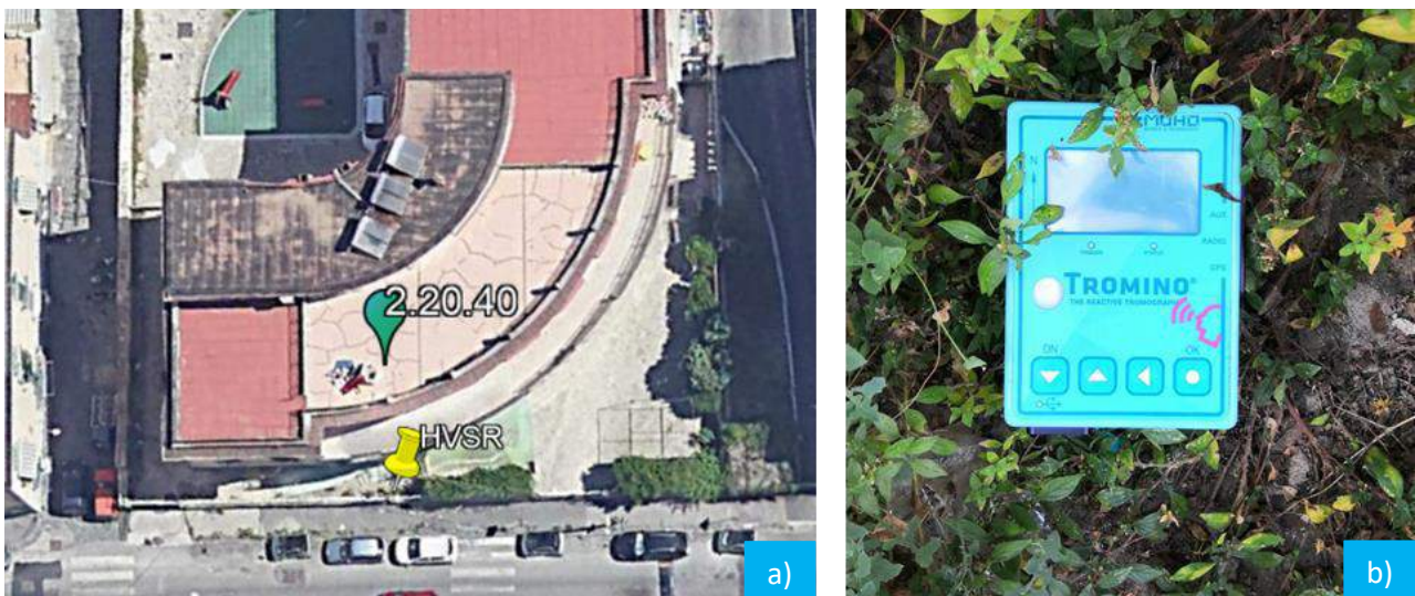
Figura 28. – Ubicazione indagine HVSR (a) e posizione in sito (b).
