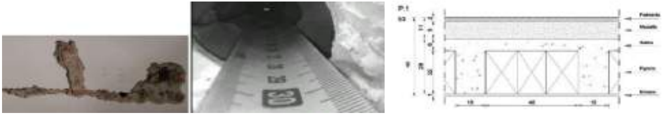
Saggio a vista all'intradosso del solaio di copertura del piano primo con endoscopia e stratigrafia E3
