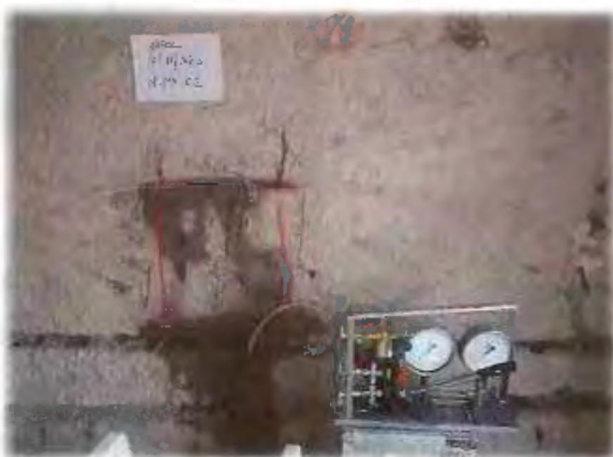
Esecuzione della prova con martinetto doppio
