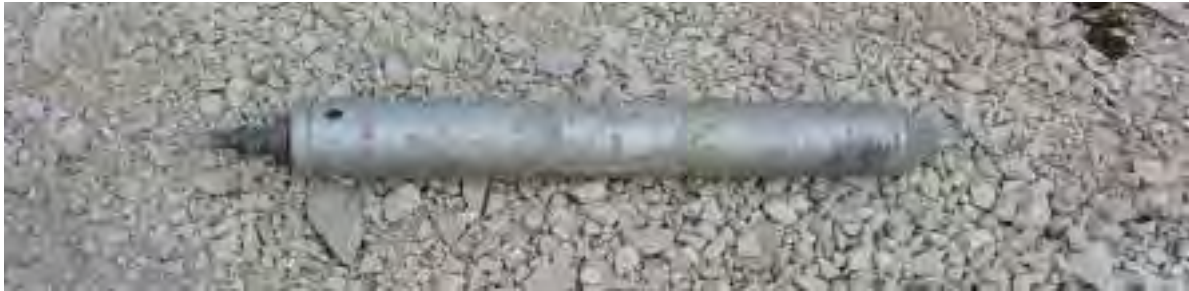
Campionatore nella posizione di infissione a pressione
