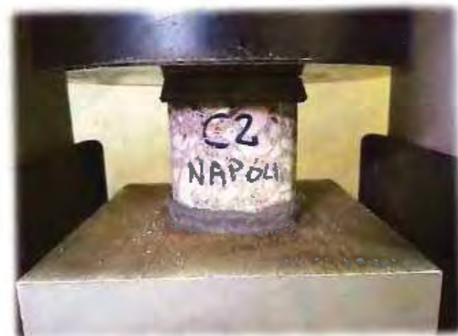
Vista dei provini sottoposti alla prova di compressione
