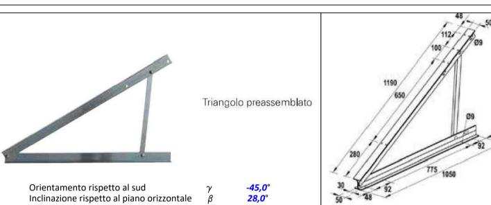
La struttura di sostegno ad inclinazione per i pannelli fotovoltaici per coperture piane sarà dimensionata e verificata in conformità alle NTC2018 (Norme Tecniche sulle Costruzioni), al DPR 380, alla circolare applicativa 02/02/2009 n. 617, agli Eurocodici specifici per la progettazione di strutture in acciaio e strutture in alluminio. Sarà valutata, altresì, la necessità di installare opportune zavorre.
