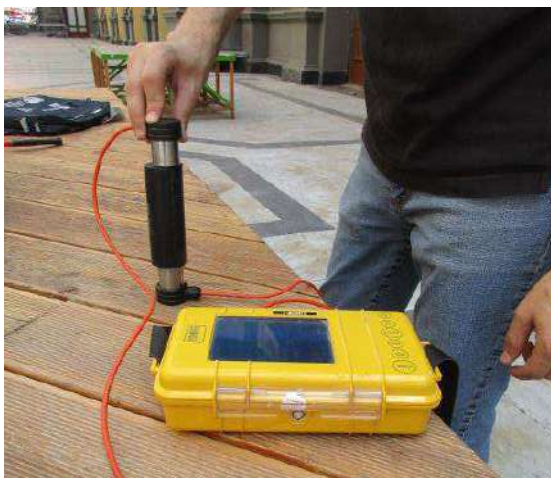
Figura 4 – Taratura della strumentazione Figura 5 - Esecuzione delle indagini soniche su muratura
