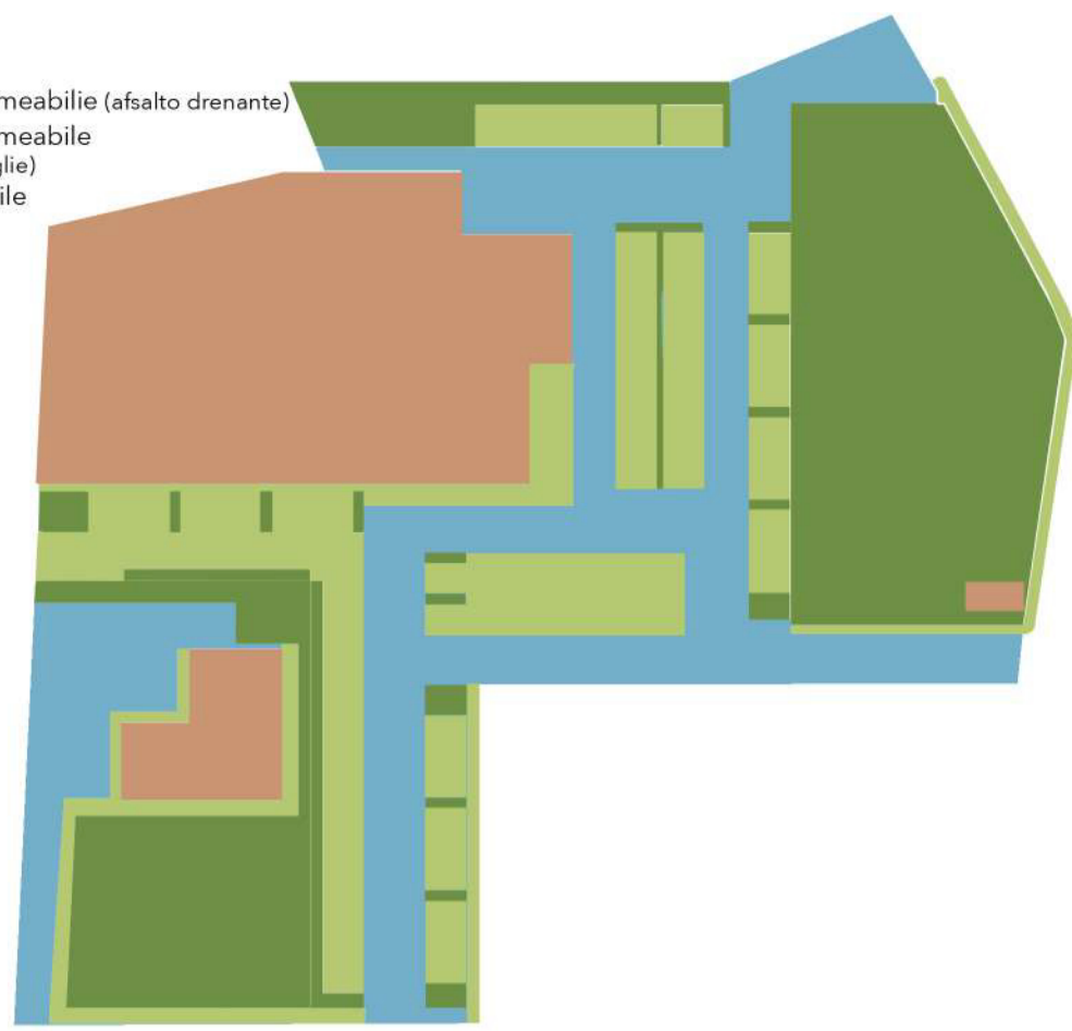
Planimetria livelli permeabilità delle superfici_scala 1:1000
