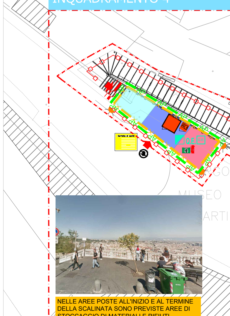
NELLE AREE POSTE ALL'INIZIO E AL TERMINE DELLA SCALINATA SONO PREVISTE AREE DI STOCCAGGIO DI MATERIALI E RIFIUTI
