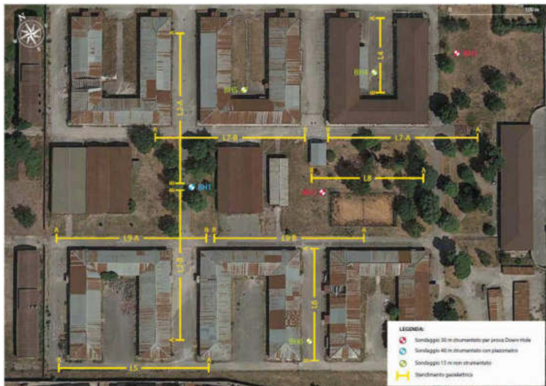
Figura 4.15: Indagini Geognostiche (2018) – Ubicazione Punti Sondaggio
