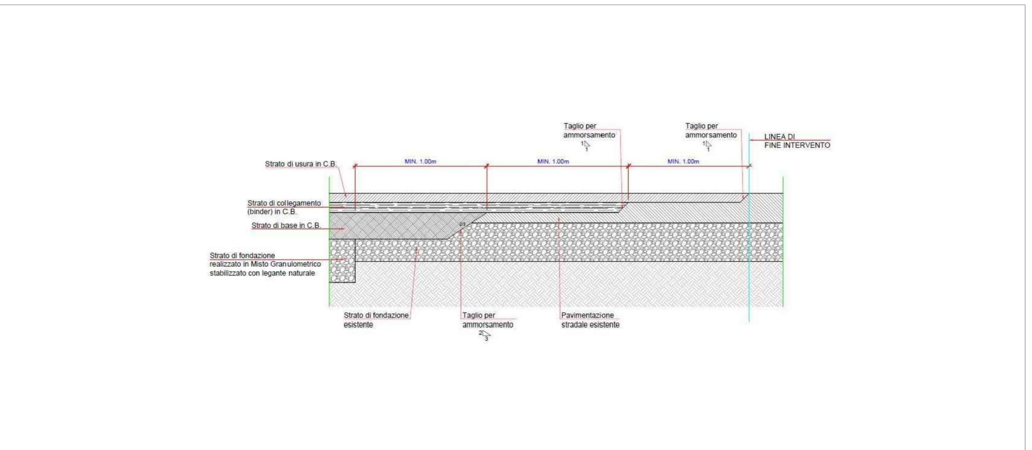
DETTAGLIO AMMORSATURA CON PAVIMENTAZIONE ESISTENTE - RAPP. 1:10
