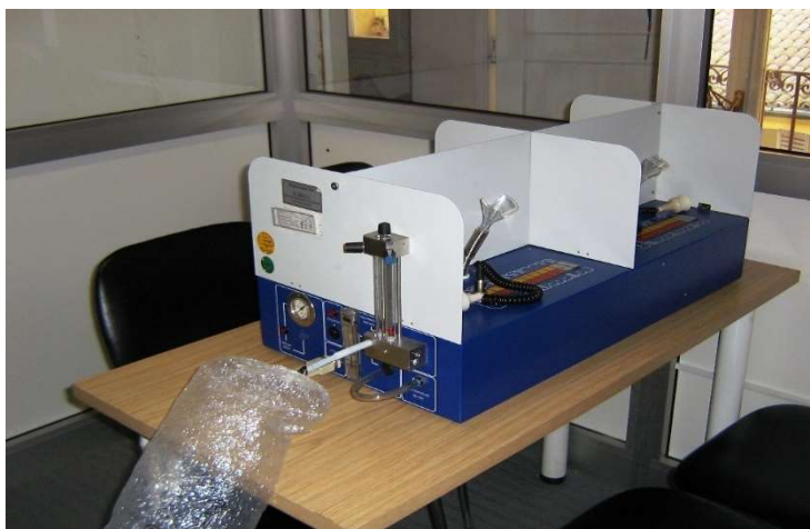
Figura 1 - L'olfattometro utilizzato per la misura della concentrazione di odore.
