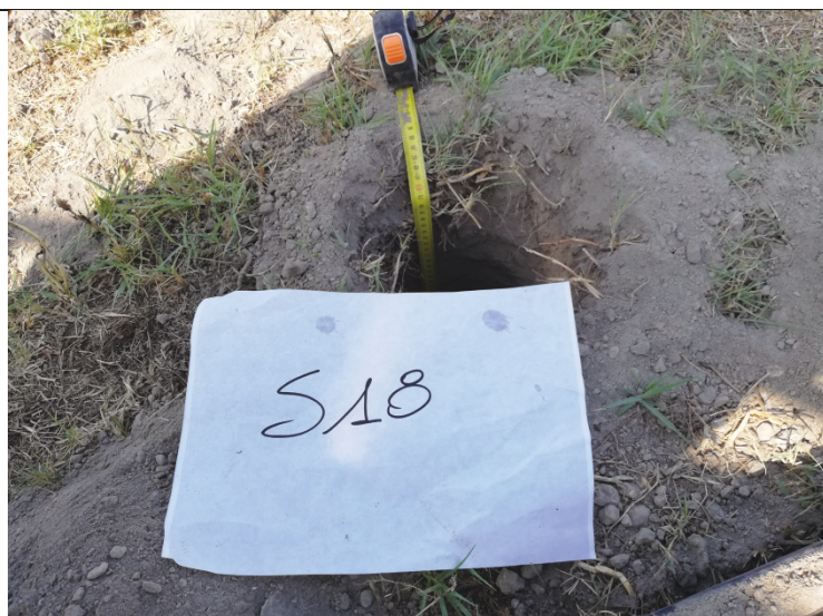
Figura 7 Verifica della profondità di perforazione
