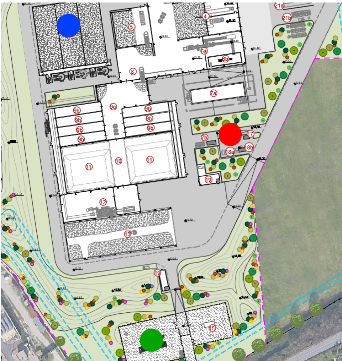
Fig.15.: Localizzazione delle sorgenti emittive in progetto (in blu il biofiltro, in rosso la caldaia, in verde l'off-gas)
