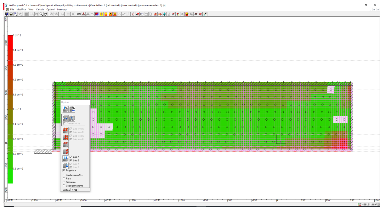
Figura 8.8 – Involuppo Momenti Mzz massimi SLU – SLV KNm
