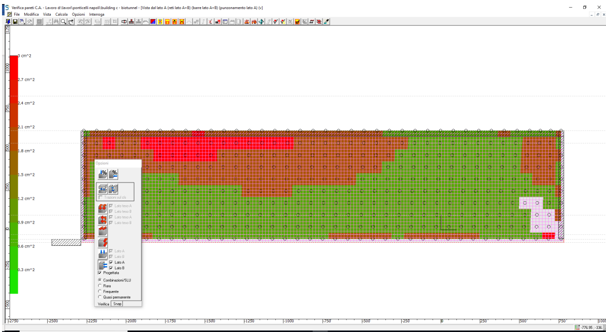
Figura 8.9 - Domanda di armatura minima nella soletta biotunnel
