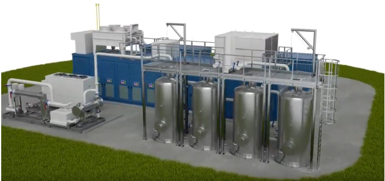
Fig.80.: Vista tridimensionale di impianto di Upgrading simile a quello in progetto
