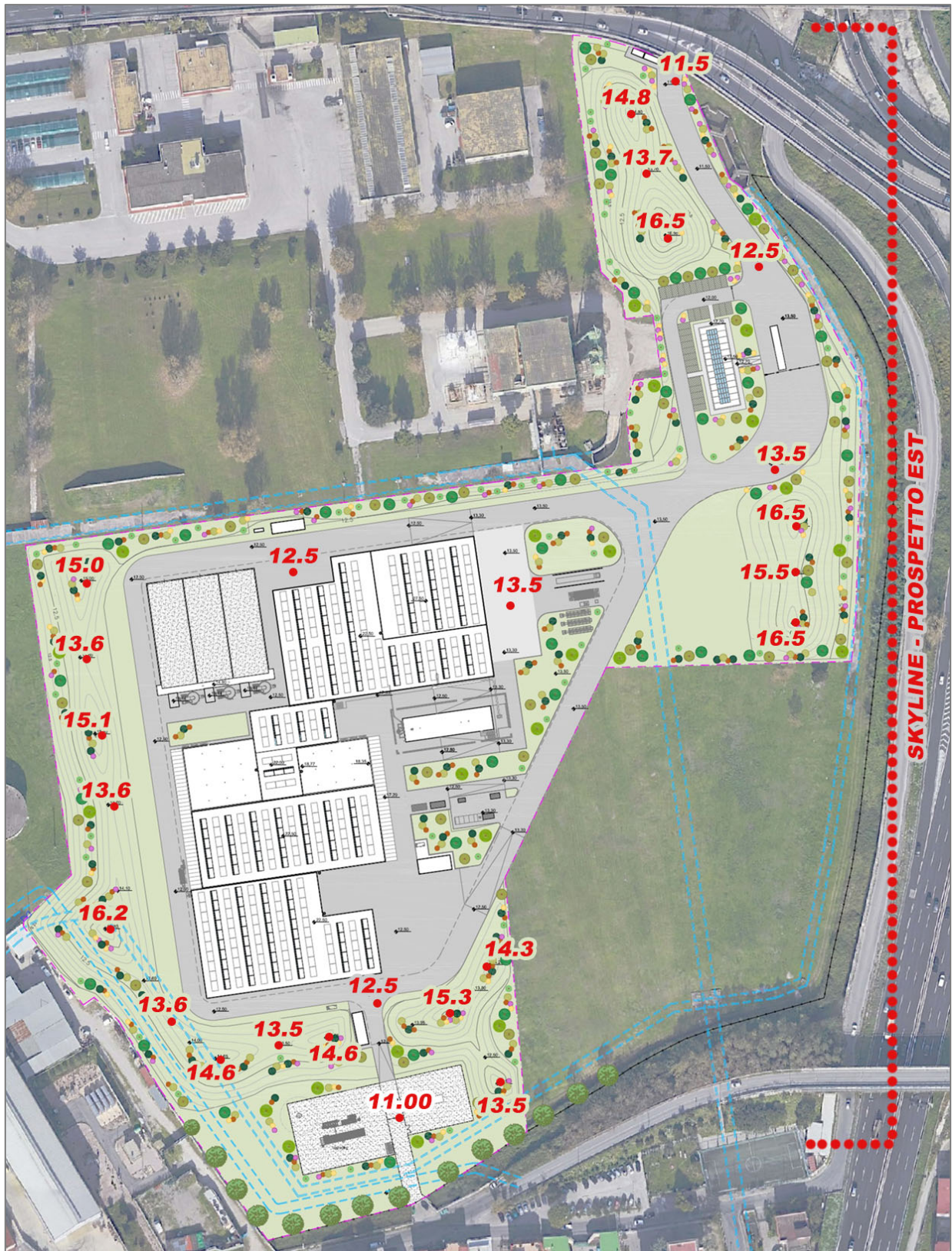
Fig.96.: Planimetria generale con indicazione delle altezze dei rilevati e della collocazione dello skyline riportato nella pagina seguente
