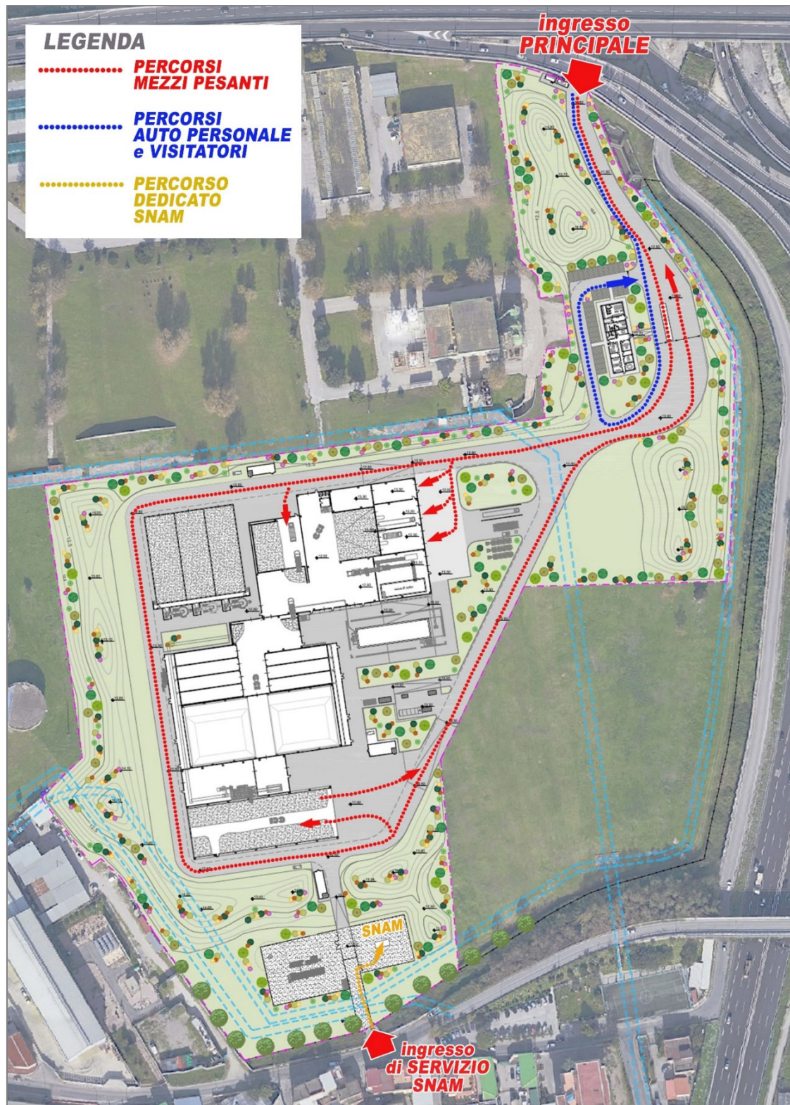
Fig.83.: Planimetria con indicazione della viabilità interna all'impianto
