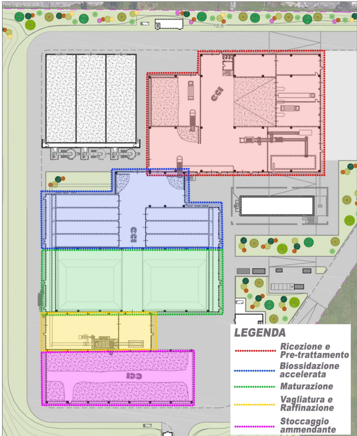
Fig.60.: Stralcio planimetrico di dettaglio dei capannoni con indicazione delle quattro porzioni che compongono l'impianto
