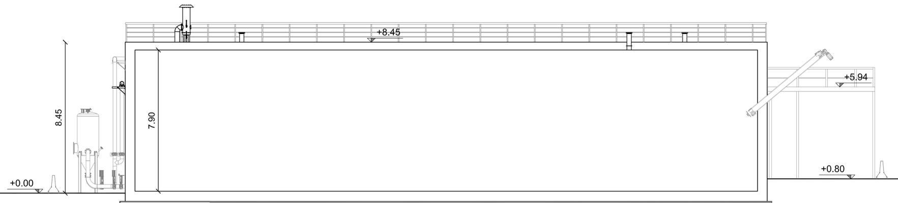
NB. La quota altimetrica +0.00 riportata nelle sezioni e nei prospetti a riferimento alla quota del pavimento finito (quota +12.50m).
