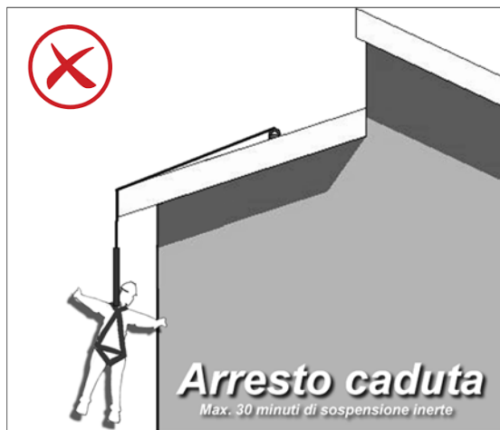
Fig. 1. Schema illustrativo arresto di caduta
