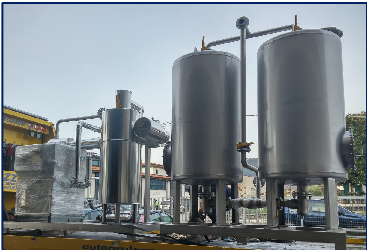
Figura 5 Installazione tipica del sistema di Essiccazione e Filtrazione
