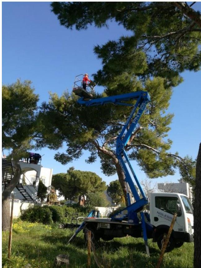
**Figura 3** – Attività di potatura con piattaforma elevatrice
