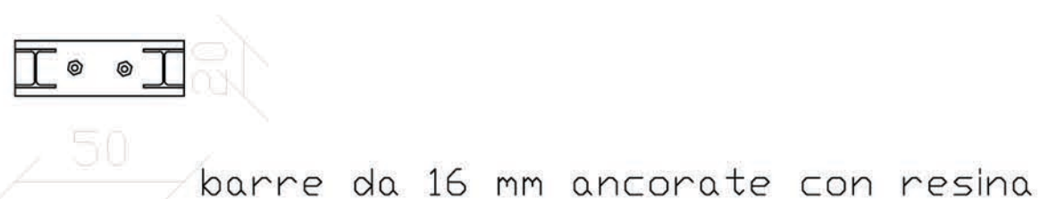
PARTICOLARE ANCORAGGIO TRAVE-CORDOLO IN CA
