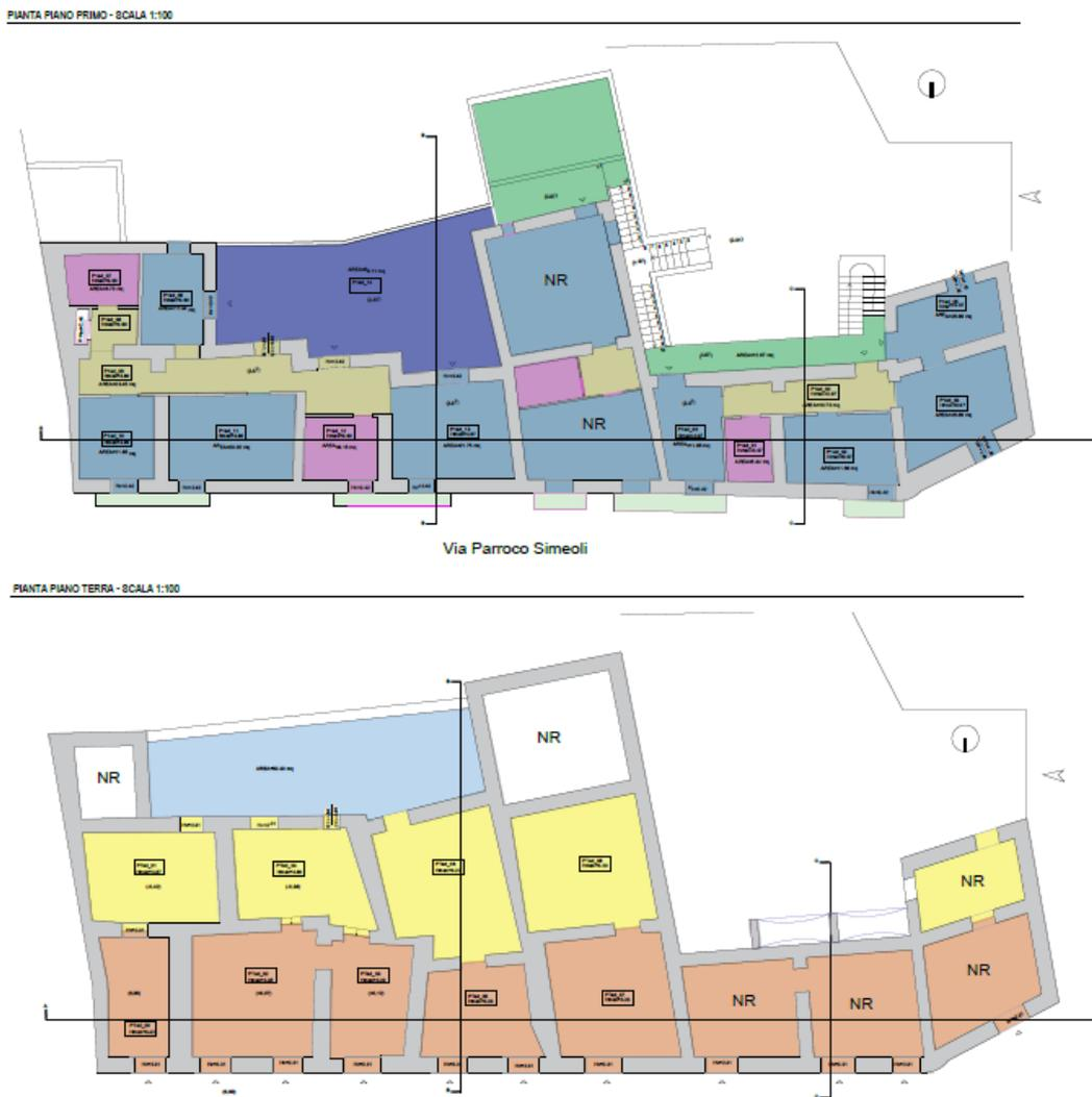
Fig. 5 – Rilievo funzionale edifici D/E (pianta piano terra in basso, pianta primo piano in alto)
